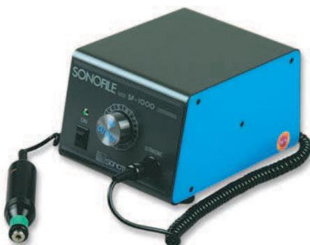
Conçu pour le polissage des moules et matrices par vibrations ultrasoniques. Il s'utilise avec une large gamme d'outils grâce à ses 24000 cycles par secondes et son amplitude de 4 à 30 microns. Le Sonofile est simple d'utilisation avec ajustement automatique de la fréquence ultrasonique.
