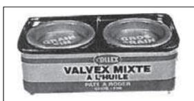
Pour le rodage de soupapes, rectification (culasses, vannes, robinets, clapets...). Utilisable sur tous les métaux. Contient de l'huile pour le rodage rapide. Livré en boîte mixte de 140 g (grain fin (220) et grain gros (120)).
