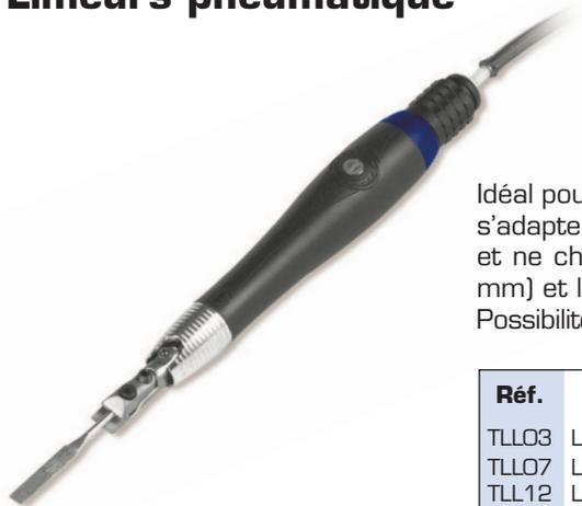
Idéal pour les opérations de polissage, cet appareil léger, équilibré et ergonomique s'adapte à toutes les situations. Grâce à sa turbine il possède un couple important et ne chauffe pas. Le mouvement latéral ou elliptique est fixe (0,3 / 0,7 / 1,2 mm) et le nombre de coups par minute se règle facilement et avec précision. Possibilité d'utiliser les outils de 0,5 à 3 mm d'épaisseur et de 4 à 10 mm de largeur.
