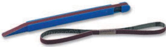
Ces polissoirs à main facilitent le polissage des matériaux difficiles ou des pièces profilées. Idéal en mécanique. Ils sont construits avec une tige en matière plastique sur laquelle est insérée une bande abrasive qui avance automatiquement sur simple pression du bouton poussoir. Usage à sec, avec eau, acétone, kérosène ou huile.
